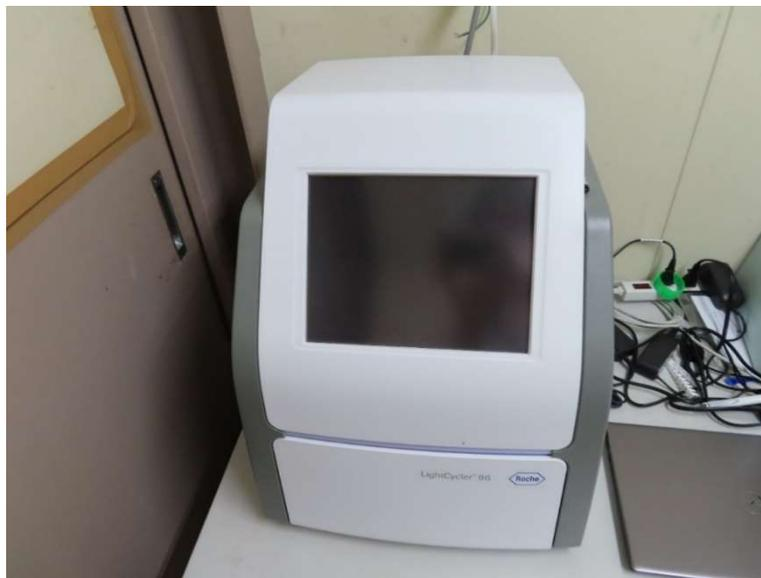
主な用途 : PCR での DNA 増幅量をリアルタイムでモニターして解析、8 連チューブと 96 ウェルプレートに対応、FAM、HEX、Texas RED、Cy5 のマルチ検出が可能
